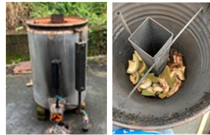
รูปที่ 3 เตาเผา และลักษณะภายในเตา
