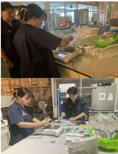
รูปที่ 6 การเตรียมดินจำนวน 12 ถุง และเติมน้ำ ในปริมาณต่างกันตามที่กำหนด
