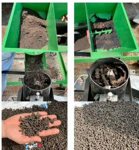
รูปที่ 4 การทดสอบเครื่องผสมพร้อมอัดเม็ด
