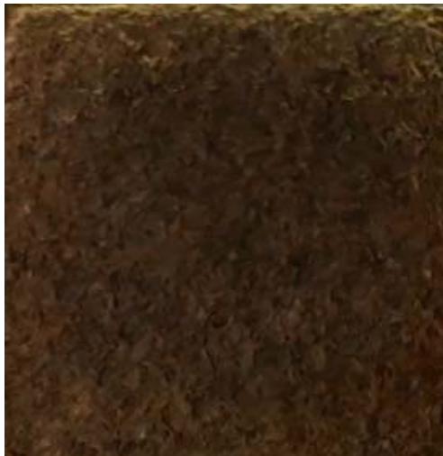
(ก) รูปแผ่นขึ้นไม้ อัดก่อนอบมีน้ำหนัก 382 กรัม และมีความชื้น 30% มีสีค่อนข้างคล้ำเพราะมีน้ำอยู่ปริมาณมาก
