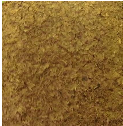
(ข) รูปแผ่นขึ้นไม้อัดหลังอบมีน้ำหนัก 335 กรัมและมีความชื้น 12% มีสีสว่างขึ้น
