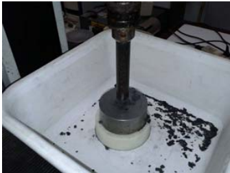
รูปที่ 3 การทดสอบหาค่าความแข็งด้วยเครื่อง Universal Testing Machine (UTM)
