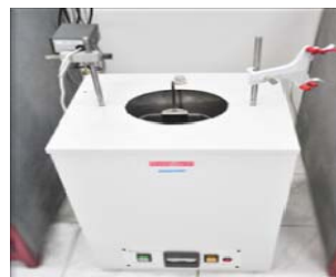
รูปที่ 2 การหาค่าความร้อนของเปลือกร่อนน้ำมันลำปะหลังและถ่านอัดแท่ง
