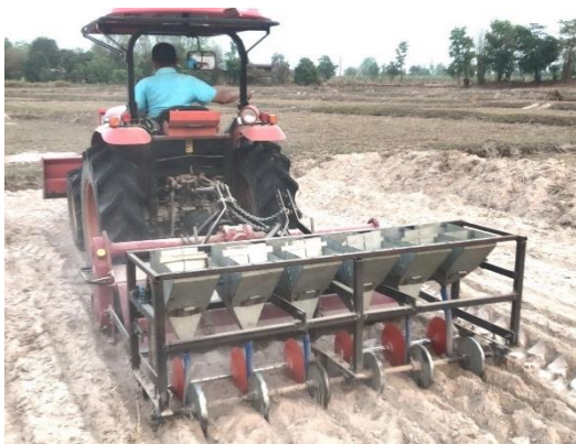
รูปที่ 8 ทดสอบหยอดข้าวในแปลงนาที่เตรียมไว้
