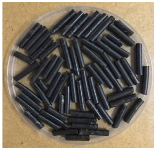
รูปที่ 5 ลักษณะเชื้อเพลิงอัดเม็ดจากกากหม้อความชื้น 30.26 เปอร์เซ็นต์ (มาตรฐานเปียก)
