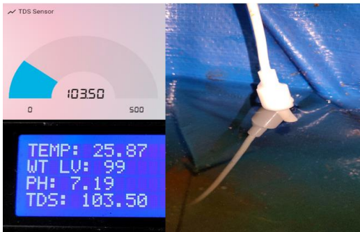
รูปที่ 8 ภาพแสดงผลการทำงานของ TDS Sensor
