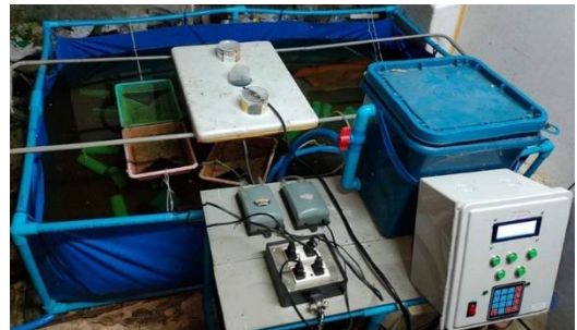
รูปที่ 5 โครงสร้างจริงของบ่อกึ่งที่ทำการทดสอบ
