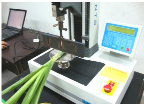
ค) การทดสอบความต้านทานแรงกดของยอดกล้วยและต้นข้าวโพด
