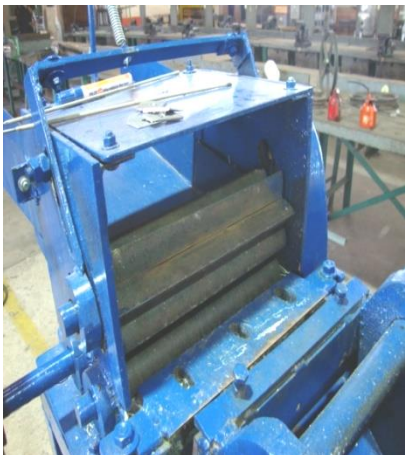
รูปที่ 4 ลูกกลิ้งบดขยี้และดันข้าวโพด
