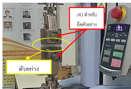
รูปที่ 3 ลักษณะการจับชิ้นงานกับ Clamp/JIG
