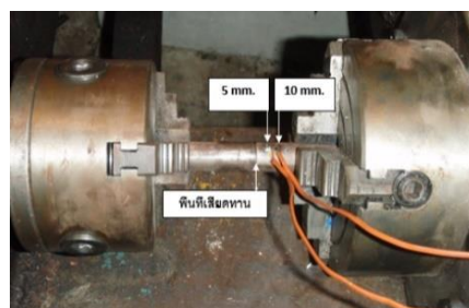
รูปที่ 2 การวัดอุณหภูมิของชิ้นงาน
