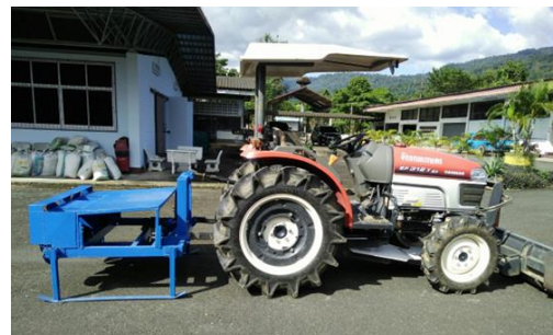
รูปที่ 2 เครื่องขับเคลื่อนสำหรับแบบติดท้ายรถแทรกเตอร์ขนาดเล็กที่สร้าง
