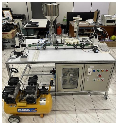
รูปที่ 3 ระบบบรรจุน้ำที่ควบคุมด้วย PLC
