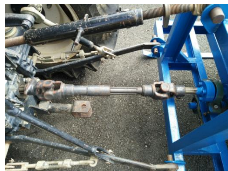
รูปที่ 3 การติดตั้งชุดถ่ายทอดกำลังของเครื่องขับเคลื่อนสำหรับแบบติดท้ายรถแทรกเตอร์ขนาดเล็ก
