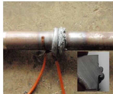
รูปที่ 11 ลักษณะการเสียรูปของชิ้นงาน
