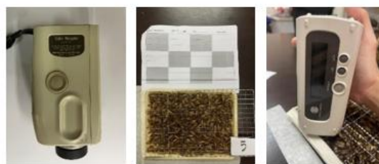
รูปที่ 2 วิธีการทดสอบการวัดสี เครื่อง Color Reader รุ่น Konica Minolta (Model CR-10)
