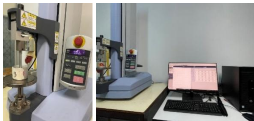
รูปที่ 3 เครื่อง Texture Analysis รุ่น Shimadzu Scientific Instruments EZ-SX texture analyzer
