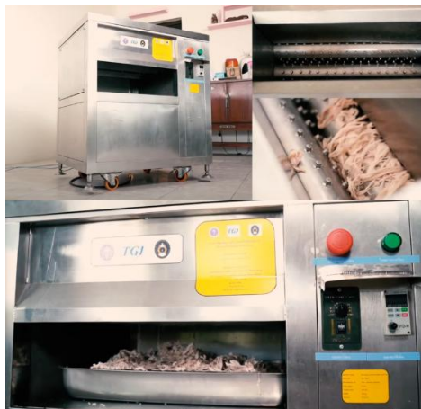
รูปที่ 3 ต้นแบบเครื่องฉีกหมูฝอยแบบกึ่งอัตโนมัติ
