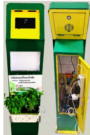
รูปที่ 2 ลักษณะกายภาพหน้าตู้จะติดตั้งกระเบื้องปูลูกพีชและด้านหลังที่ภายในบรรจุอุปกรณ์อิเล็กทรอนิกส์
