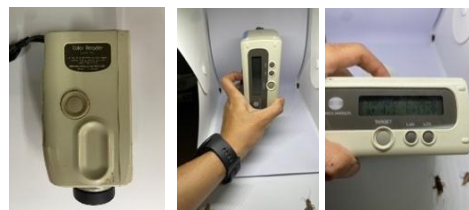
ภาพที่ 4 วิธีการทดสอบการวัดสี เครื่อง Color Reader รุ่น Konica Minolta (Model CR-10)
