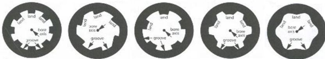
ภาพที่ 2 ร่องเกลียวและสันเกลียวภายในลำกล้องปืนแบบ Conventional Rifling, Ratchet Rifling, Enfield Rifling, Hybrid Rifling, Polygonal Rifling จากซ้ายไปขวาตามลำดับ [6]
