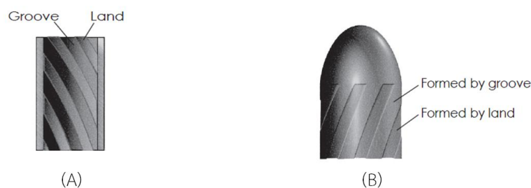
ภาพที่ 1 (A) ร่องเกลียวสันเกลียวภายในลำกล้องปืน, (B) รูปแบบของรอยคำหันทิเศษที่เกิดขึ้นบนพื้นผิวลูกกระสุนปืน [3]
