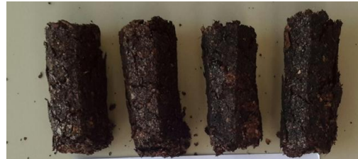
เชื้อเพลิงอัดแท่งที่ใช้แป้งมันสำปะหลังเป็นตัวประสาน จากการอัดด้วยเครื่อง ที่อัตราส่วน 1 : 1.4
