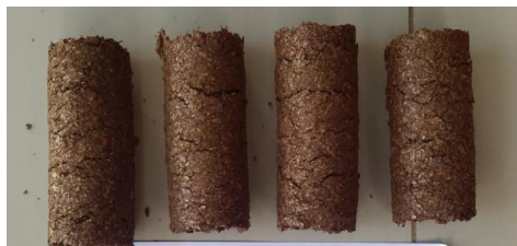
เชื้อเพลิงอัดแท่งที่ใช้แป้งมันสำปะหลังเป็นตัวประสาน จากการอัดด้วยมือ ที่อัตราส่วน 1 : 1.4
