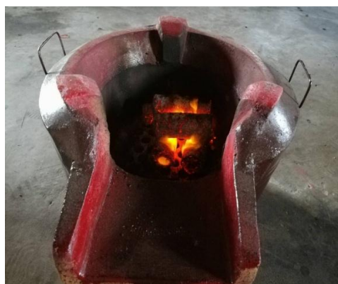
ภาพที่ 6 ลักษณะการเผาไหม้ และการคงรูปถ่านขณะที่ติดไฟ
