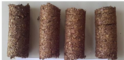
เชื้อเพลิงอัดแท่งที่ใช้น้ำยางพาราเป็นตัวประสาน จากการอัดด้วยมือที่อัตราส่วน 1 : 1.4
