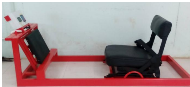
ภาพที่ 1 แสดงเครื่องมือวัดความแข็งแรงของกล้ามเนื้อขา ที่ผู้วิจัยสร้างขึ้น
