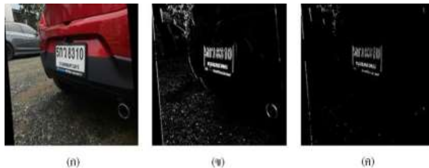
ภาพที่ 3 ผลการทดลอง (ก) ผลการแก้ไขภาพเอียง (ข) ผลการค้นหาขอบภาพโซเบล (ค) ผลการแปลงภาพเทรสโธล
