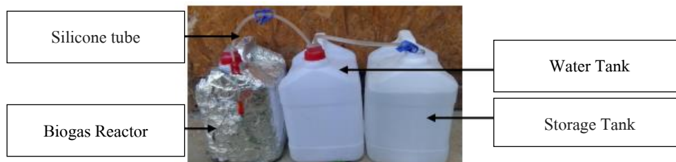
ภาพที่ 1 การทดลองแบบกะ ที่ effective volume 5 ลิ ระยะเวลาเก็บกัก 48 วัน และใน 1 เซตประกอบด้วย 3 แกลงลอน :
