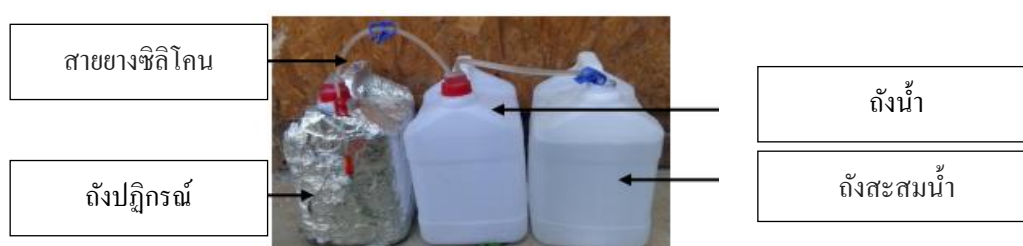
ภาพที่ 1 การทดลองแบบกะ ที่ effective volume 5 ลิ ระยะเวลาเก็บกัก 20 วัน และใน 1 เซตประกอบด้วย 3 แกลงลอน : ถังปฏิกรณ์ ถังน้ำ และถังสะสมน้ำ
