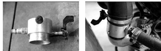
ภาพที่ 9 มิกเซอร์และการดัดแปลงก่อนปล่อยก๊าซชีวภาพเข้าคาร์บูเรเตอร์
