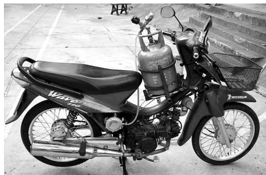
ภาพที่ 10 ต้นแบบรถจักรยานยนต์พลังงานก๊าซชีวภาพ
