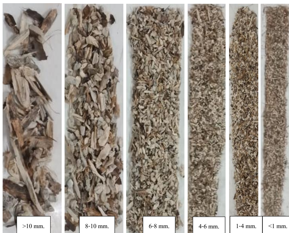
ภาพที่ 6 ลักษณะของชิ้นลำต้นมันสำปะหลังที่ผ่านการสับลดขนาด
