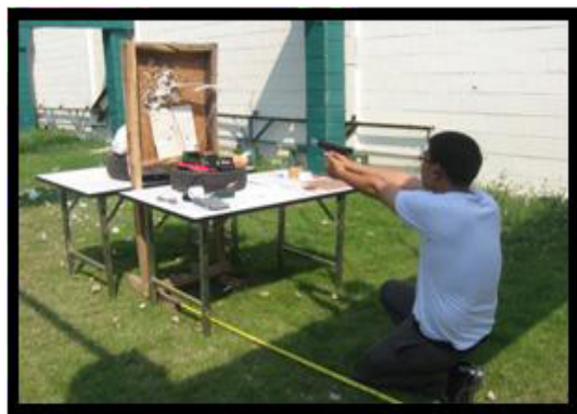
ภาพที่ 1 แสดงภาพการหาระยะทางด้วยเครื่องวัดความเร็วลูกกระสุนปืน (Shooting Chrony Ballistic Printer)
