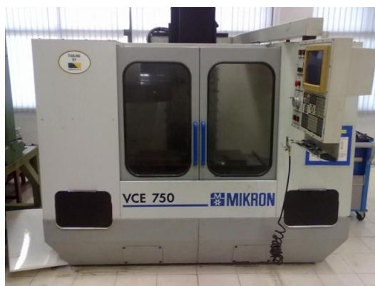
รูปที่ 1 เครื่องกัตต์อัตโนมัติ MIKRON รุ่น VCE750
