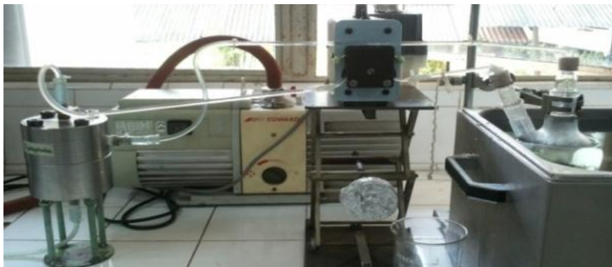
ภาพที่ 2 แสดงลักษณะการป้อนของสารละลายผสมผ่านเยื่อเลือกผ่านโมดูล
