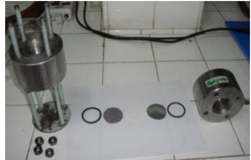
ภาพที่ 1 ส่วนประกอบของชุดเพอร์เวพอเรชันโมดูล (Pervaporation Module) และเยื่อเลือกผ่าน
