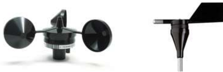
ภาพที่ 4 เครื่องวัดความเร็วลม (Anemometer) (ซ้าย) เครื่องวัดทิศทางลมหรือศรลม (Wind Vane) (ขวา)
