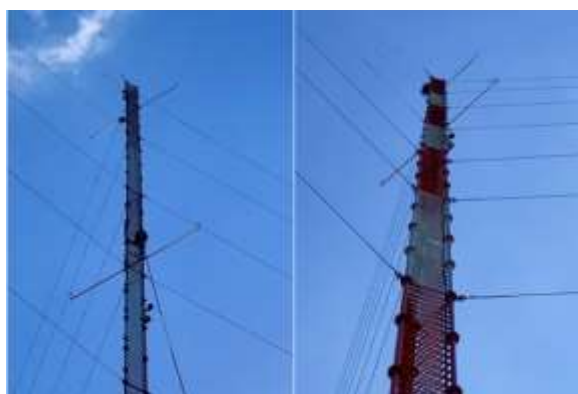
ภาพที่ 3 ลักษณะการติดตั้งอุปกรณ์ตรวจวัดความเร็วลมบนเสาที่ความสูง 2 ระดับ
