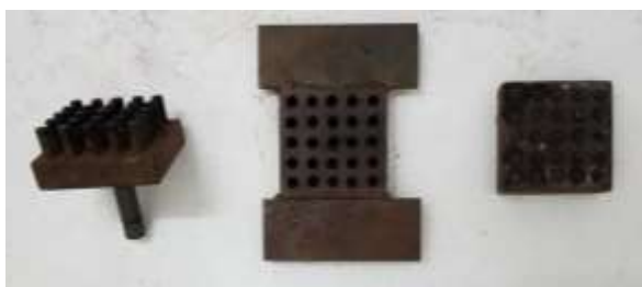
ภาพที่ 2 บล็อกสำหรับอัดเม็ดและเครื่องอัดไฮดรอลิก
