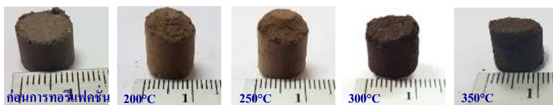
ภาพที่ 4 ลักษณะทางกายภาพของกากหม้อกรองอัดเม็ดที่ก่อนการทอริแฟกชันและหลังการทอริแฟกชัน ที่อุณหภูมิต่าง ๆ เป็นเวลา 0.5 ชั่วโมง
