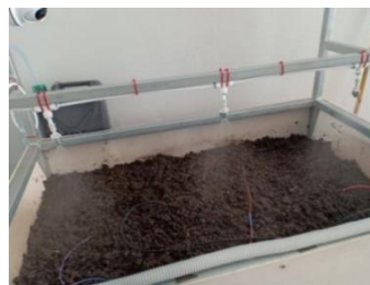
ภาพที่ 5 การวัดค่าอุณหภูมิและความชื้นและการพ่นน้ำอัตโนมัติ
