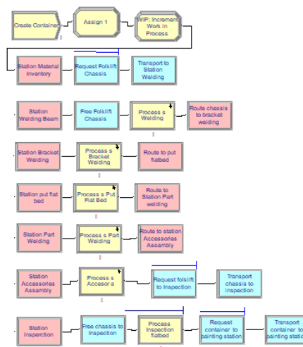
ภาพที่ 4 แบบจำลองย่อยสำหรับการผลิตรถกึ่งพ่วงแบบพื้นเรียบ
