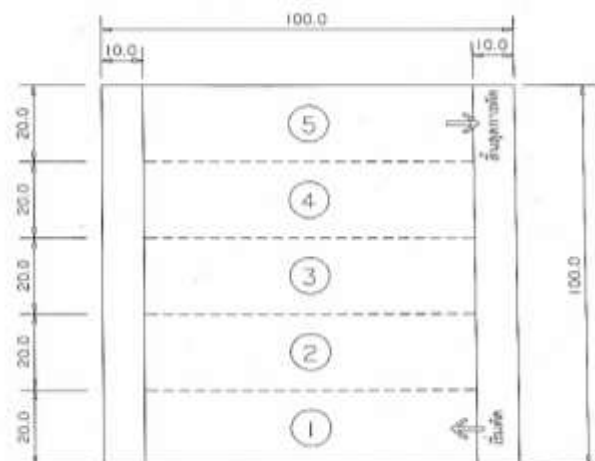
ภาพที่ 7 กำหนดขนาดพื้นที่ที่ใช้ทดสอบตัดต่อซังข้าว (หน่วยเป็นเมตร)
