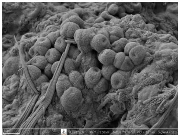
ภาพที่ 3 จุลินทรีย์ในระบบ EBPR เมื่อส่องด้วยกล้อง SEM ที่กำลังขยาย 10,000x
