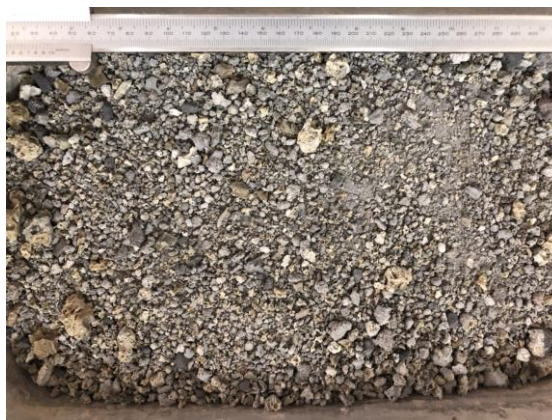
ภาพที่ 2 ถ้ำก้นเตาจากโรงไฟฟ้า BLCP Power จำกัด
