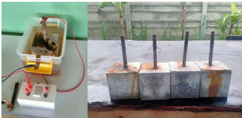
ภาพที่ 2 การติดตั้งชุดทดสอบการกัดกร่อน
