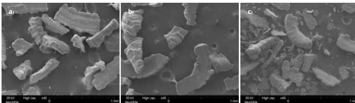
ภาพที่ 1 ภาพ SEM แสดงลักษณะทางกายภาพของผงอะลูมิเนียมเกรด A356 ที่ผ่านการตีบ้นลดขนาด อนุภาคผง โดยเฉลี่ย a) 250 ไมครอน b) 180 ไมครอน และ c) น้อยกว่า 180 ไมครอน
