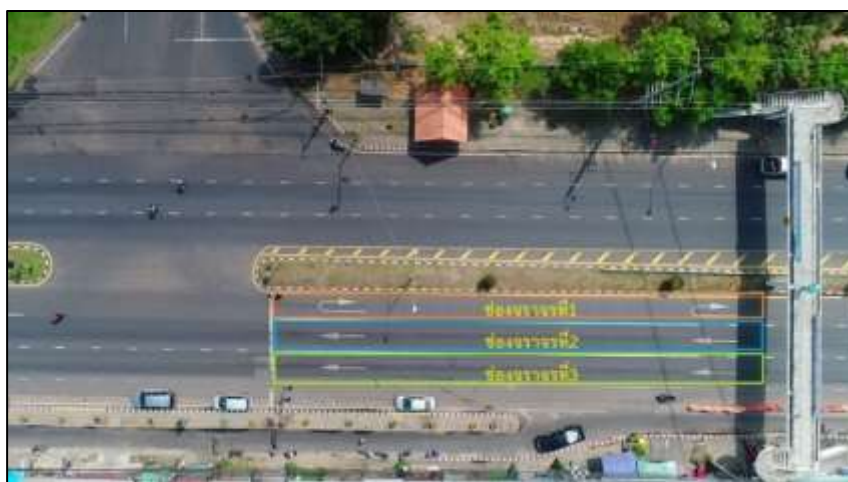
ภาพที่ 5 ตัวอย่างการแบ่งช่องจราจรในการวิเคราะห์ของทางแยกหน้ามหาวิทยาลัยอุบลราชธานี
