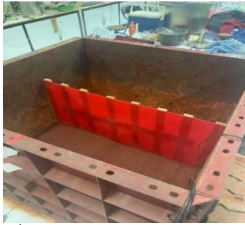
ภาพที่ 5 การบดอัดดินในโมลตัวอย่าง
