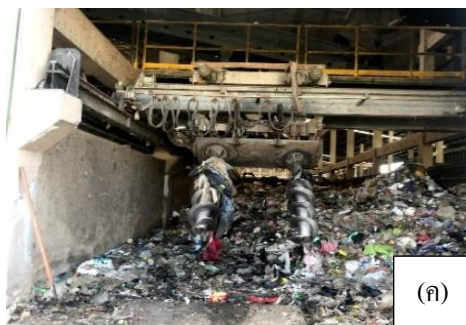
ภาพที่ 4 ภาพกระบวนการกำจัดขยะแบบ MBT เทศบาลตำบลร้อยเอ็ด จังหวัดร้อยเอ็ด ประเทศไทย ลำดับจาก (ก) นำมูลฝอยชุมชนซึ่งน้ำหนัก (ข) เข้าโรงคัดแยก (ค) เข้าโรงสับย่อย และหมักจากนั้นนำไปร่อน (ง) แบ่งเป็น RDF และขยะอินทรีย์
