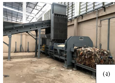
ภาพที่ 4 ภาพกระบวนการกำจัดขยะแบบ MBT เทศบาลตำบลร้อยเอ็ด จังหวัดร้อยเอ็ด ประเทศไทย ลำดับจาก (ก) นำมูลฝอยชุมชนซึ่งน้ำหนัก (ข) เข้าโรงคัดแยก (ค) เข้าโรงสับย่อย และหมักจากนั้นนำไปร่อน (ง) แบ่งเป็น RDF และขยะอินทรีย์
