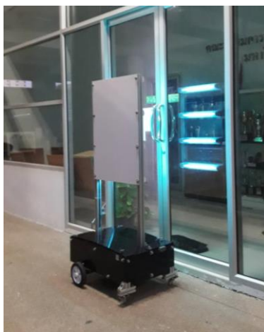
ภาพที่ 23 การทดสอบการใช้งานระบบ Wall keeping ร่วมกับการเปิดหลอดรังสียูวีซี (UVC) เพื่อทำการฆ่าเชื้อไวรัสที่อาจอยู่บนผนังหรือประตูห้องต่างๆ
