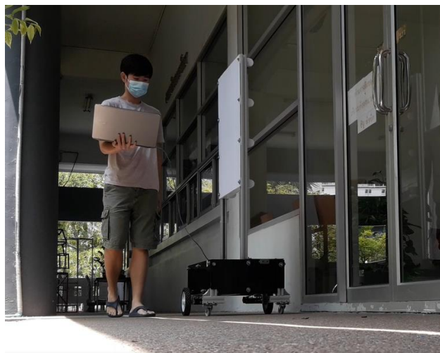
ภาพที่ 19 การทดลองการเคลื่อนที่แบบอัตโนมัติขนานกับผนัง/กำแพงในช่วง 20-40 เซนติเมตร
