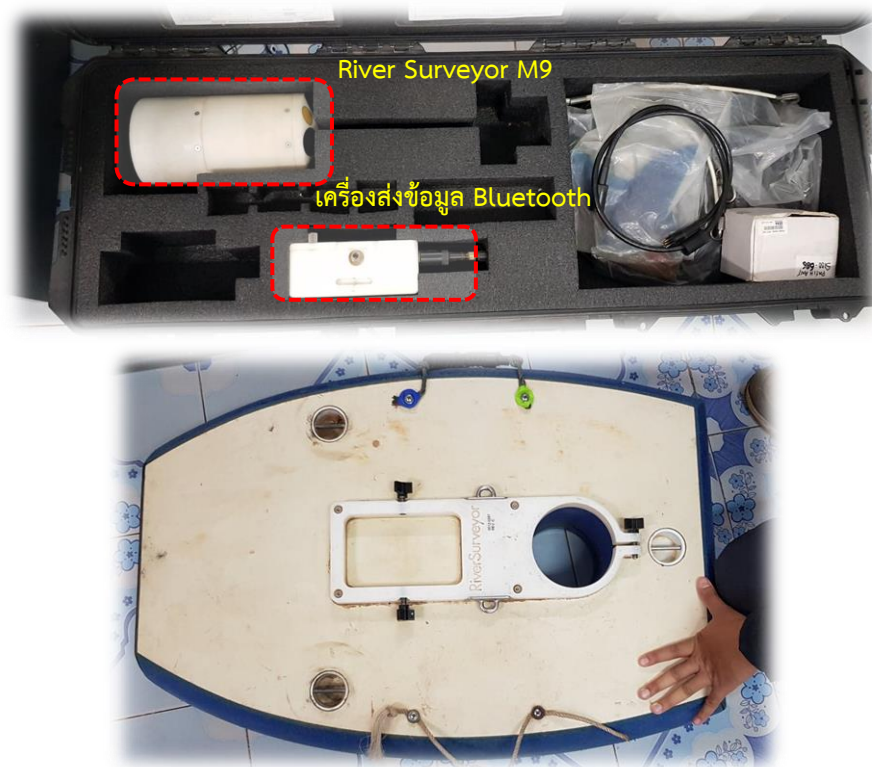
ภาพที่ 1 เครื่องมือ River Surveyor M9
