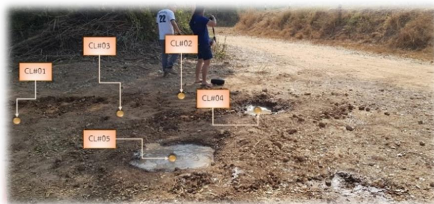
ภาพที่ 5 ภาพแสดงตำแหน่งทั้งหมดของการทดสอบการกัดเซาะชั้นดินเหนียวและดินทราย
