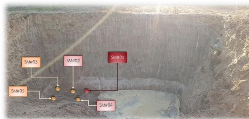
ภาพที่ 5 ภาพแสดงตำแหน่งทั้งหมดของการทดสอบการกัดเซาะชั้นดินเหนียวและดินทราย
