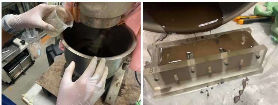
ภาพที่ 5 ขั้นตอนการเตรียมตัวอย่างจีโอโพลิเมอร์
