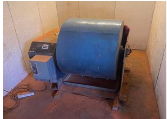
ภาพที่ 3 ภาพตัวอย่างการบดละเอียดดินลมหอบ โดยเครื่อง Los Angeles
