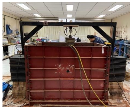
ภาพที่ 9 การวางโครงเหล็กและน้ำหนักบรรทุก
