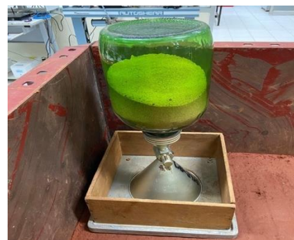
ภาพที่ 7 การทดสอบหาความหนาแน่นของดิน
