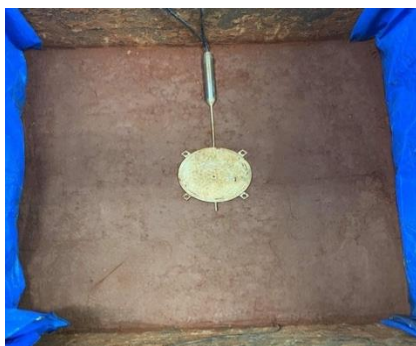
ภาพที่ 6 ภาพการติดตั้งเครื่องมือ Earth Pressure Cell ที่ความลึก 0.01, 0.2 และ 0.4 เมตรจากผิวดิน
