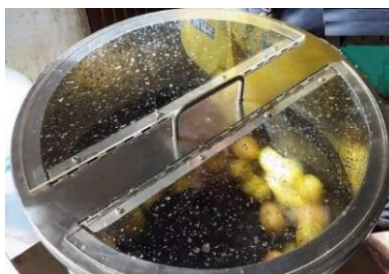
ภาพที่ 8 เครื่องขัดผิวจันทน์เทศกำลังขัดผิวจันทน์เทศ
