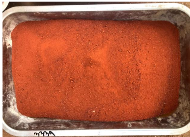
ภาพที่ 1 ดินลูกรังที่ใช้ในการทำบล็อกประสาน
