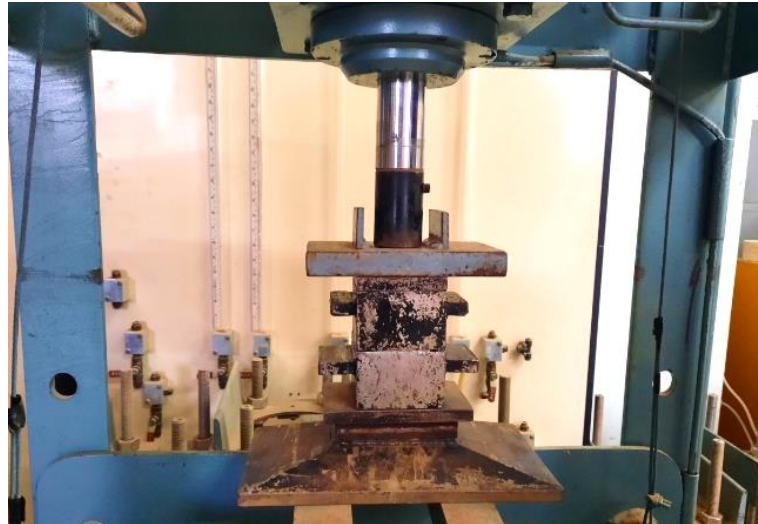
ภาพที่ 3 การอัดขึ้นรูปบล็อกประสานโดยใช้เครื่องอัดไฮดรอลิก
