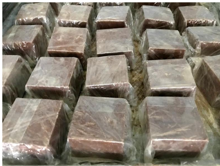
ภาพที่ 4 การบ่มบล็อกประสานด้วยการฉีดพรมน้ำและหุ้มด้วยพลาสติก
