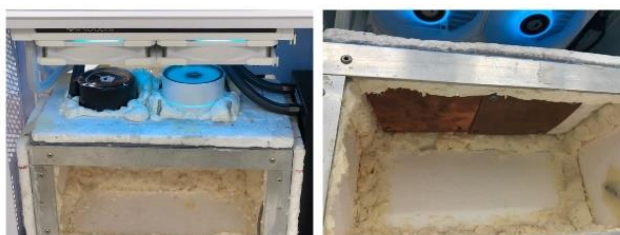
ภาพที่ 12 เครื่อง SCMTM ที่ทำ ความเย็นโดยใช้หลักการนำความเย็น เมื่อใช้แผ่น TEC จำนวน 4 แผ่น
