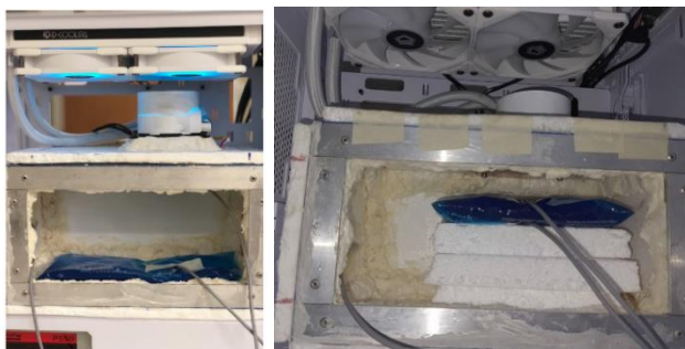
ภาพที่ 9 การทดสอบการทำความเย็นของเครื่อง SCMTM เมื่อใช้หลักการพาความร้อนจากแผ่น TEC 2 แผ่น ด้วยพัดลมจำนวน 2 ตัวไปยังแผ่น CP (รูปด้านซ้าย) และ ของเครื่อง SCMTM เมื่อใช้หลักการนำความร้อนจากแผ่น TEC 2 แผ่น ผ่านแผ่นทองแดงไปยังแผ่น CP (รูปด้านขวา)
