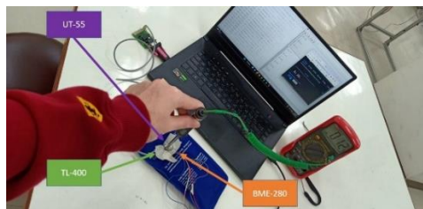
ภาพที่ 5 การทดสอบประสิทธิภาพและความแม่นยำของเซนเซอร์วัดอุณหภูมิ DTS-01 และ BME280 เทียบกับ UT55 Multimeter เมื่อวัดอุณหภูมิแผ่น CP
