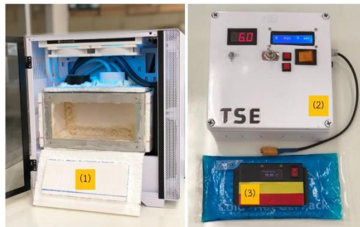
ภาพที่ 8 (1) เครื่อง SCMTM (2) กล่องควบคุม (3) กล่อง RTM ตัวที่ 1 ที่ใช้ร่วมกับแผ่น CP
