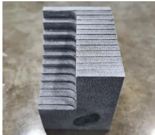
ภาพที่ 3 ชิ้นงานหลังการพ่นสเปรย์แบ่ง พร้อมสำหรับการวัดด้วยเครื่องวัดแบบไม่สัมผัส
