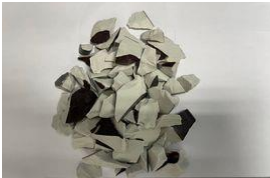
ภาพที่ 1 ลูกถ้วยไฟฟ้าที่ชำรุด
