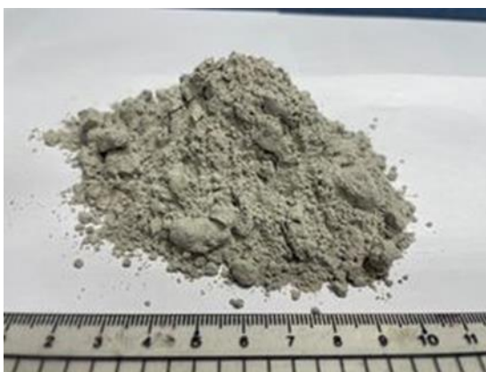
ภาพที่ 2 ลูกถ้วยไฟฟ้าบด
