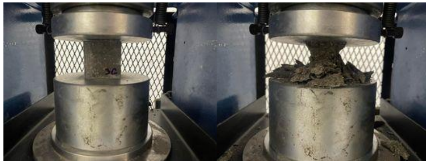
ภาพที่ 3 แสดงการทดสอบกำลังอัดของมอร์ตาร์
