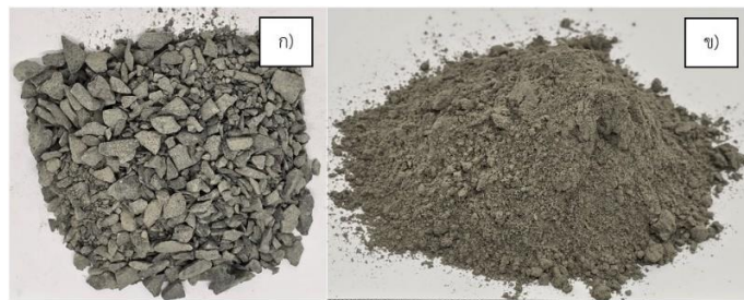
ภาพที่ 1 เศษหินบะซอลต์ ก) ก่อนบด และ ข) หลังบด
