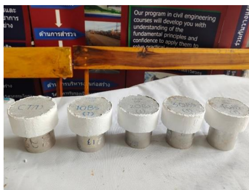
ภาพที่ 6 การเคลือบตัดตัวอย่างมอร์ตาร์ด้วยอีพ็อกซี
