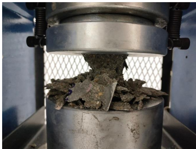
ภาพที่ 4 การทดสอบกำลังอัดของมอร์ตาร์
