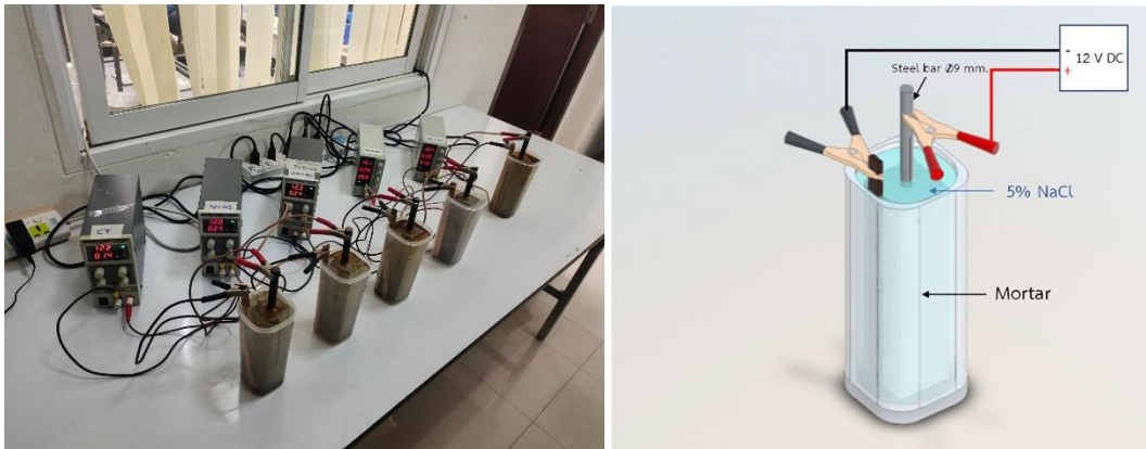
ภาพที่ 9 การทดสอบการกัดกร่อนแบบเร่ง
