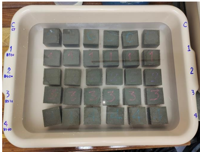
ภาพที่ 3 ก้อนตัวอย่างทดสอบกำลังอัด
