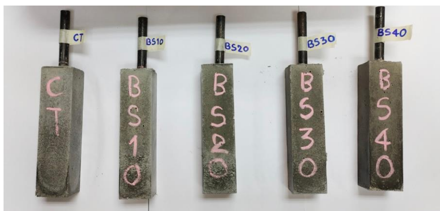
ภาพที่ 8 ตัวอย่างมอร์ตาร์สำหรับทดสอบความต้านทานการกัดกร่อนเหล็กเสริมเนื่องจากคลอไรด์
