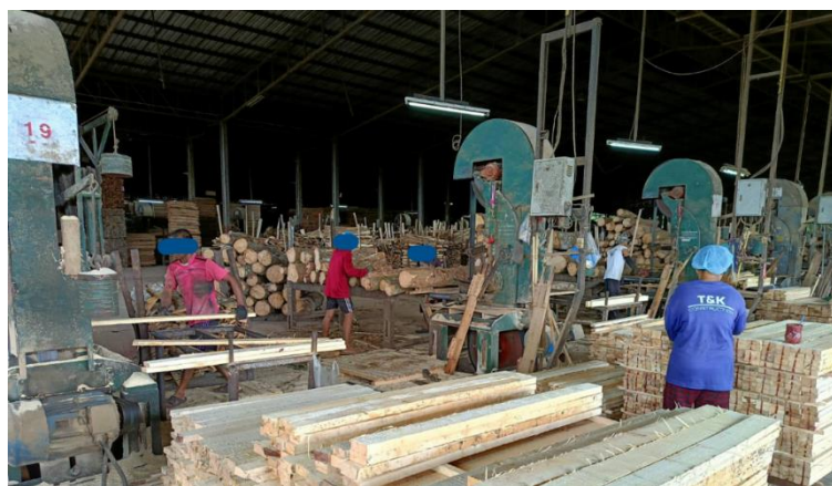
ภาพที่ 3 รายละเอียดลักษณะงานของพนักงานในแผนกเครื่องเลื่อยสายพานในโรงเลื่อยไม้ยางพาราในประเทศไทย
