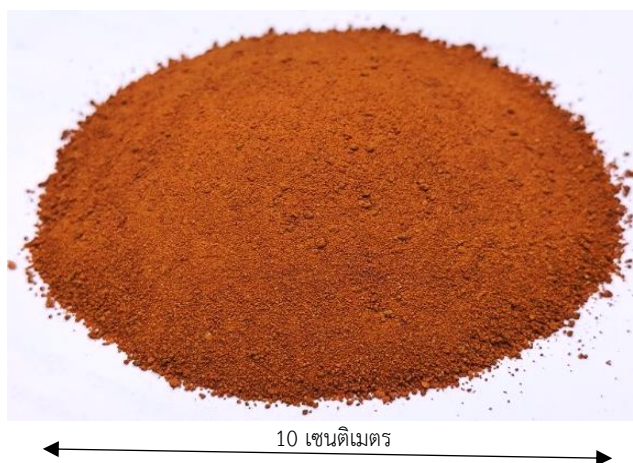
ภาพที่ 1 ดินลูกรังที่ผ่านตะแกรงเบอร์ 16
