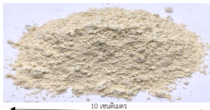
ภาพที่ 3 ซีโอไลท์เหลือทิ้งจากอุตสาหกรรมผ่านการบดละเอียดและร่อนผ่านตะแกรงเบอร์ 200
