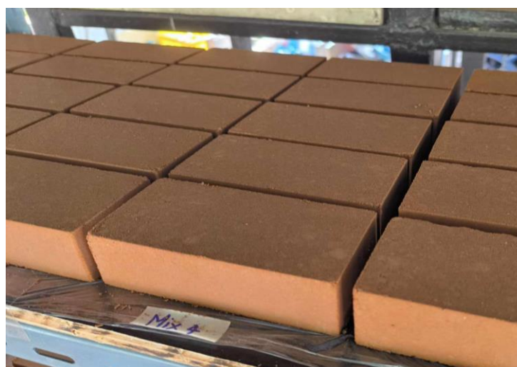
ภาพที่ 5 อิฐมอญที่อัดขึ้นรูปขนาด 65 มม. x 140 มม. x 40 มม.
