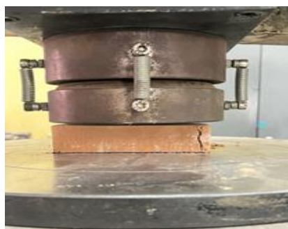
ภาพที่ 6 การทดสอบกำลังอัดของอิฐมอญ
