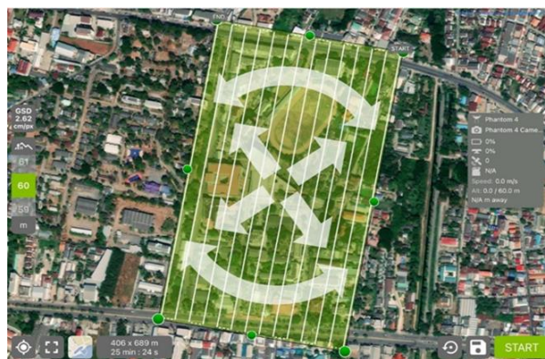
ภาพที่ 2 แนวการบินและความสูงในการบินด้วย Application Pix4D
