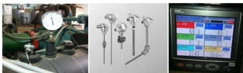
ภาพที่ 4 เครื่องวัดอุณหภูมิแบบเทอร์โมคัปเปิลและเครื่องบันทึกข้อมูล (ยี่ห้อ PM รุ่น PM TSP-08(S4)6x150MM)
