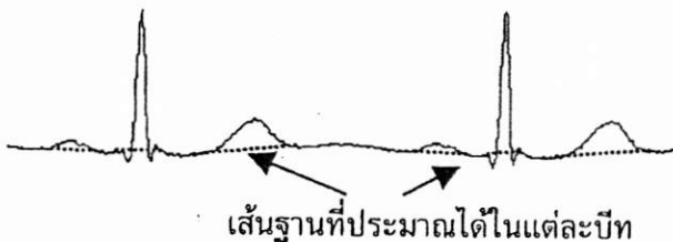
รูปที่ 6 การประมาณเส้นฐานโดยใช้เทคนิคสโปลนเชิงเส้น การหาขนาดสามารถประมาณจากเส้นฐานที่ได้
