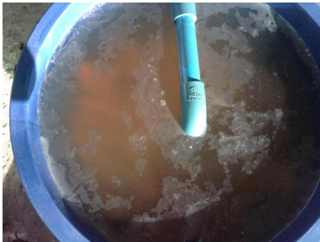
ภาพที่ 6 ตะกอนสีดำที่เกิดขึ้นในถังกรองไร้อากาศที่บรรจุตัวกลางไม้นไผ่
